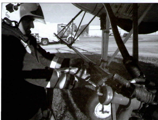
5. kép. A Ka-26-os helikopter feltöltése a gépjárműfecskendőn keresztül
